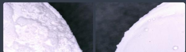
La imagen muestra BioRoot™ Flow sumergido en solución salina tamponada con fosfato, (PBS - imagen izquierda) frente a agua (imagen derecha)
